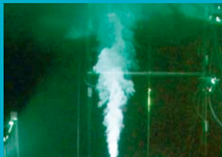
Essai de feu de torche d'hydrogène avec caractérisation de la température de flamme dans le cadre du projet Drive
