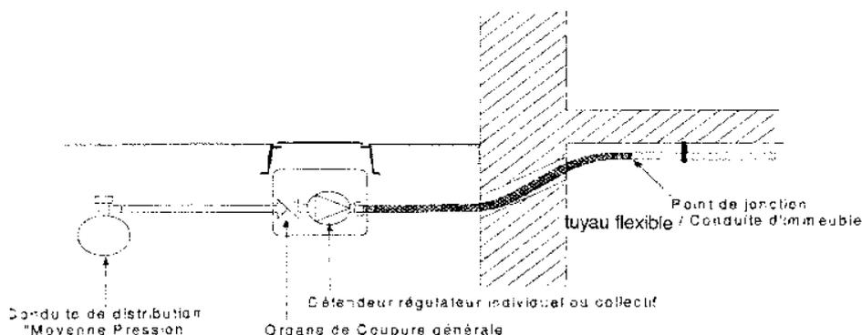
**Figure 1 : Exemple de localisation d'un « flexible pénétration »**
