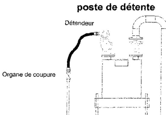
**Figure 2 : Exemple de localisation d'un « flexible détendeur »**
