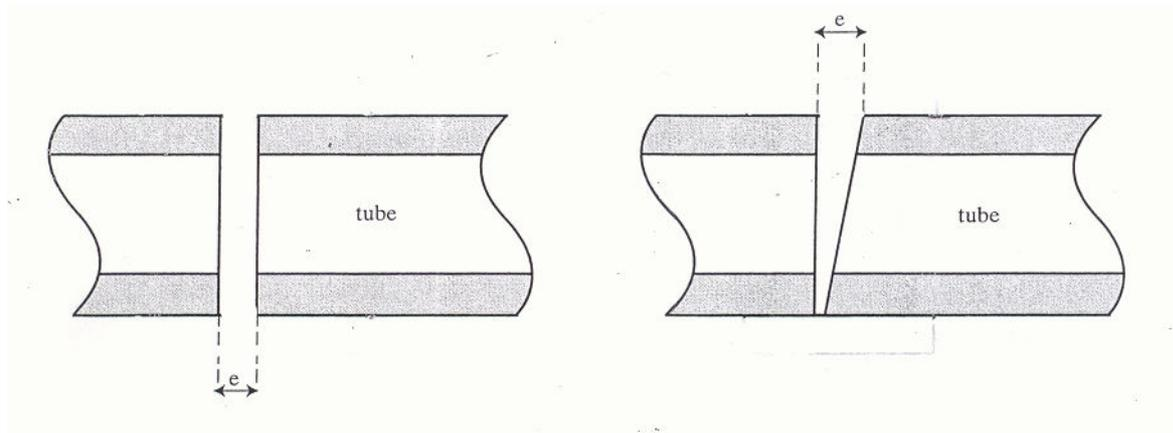
Espace maximal  $e$  admissible entre les tubes (mm).
