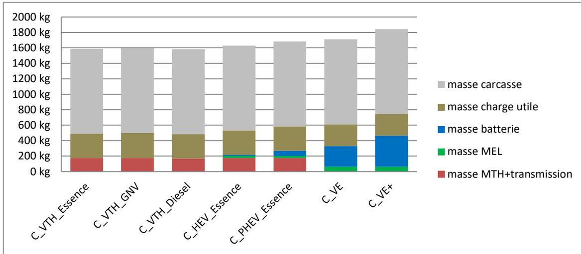
**Figure 4 : Décomposition massique des véhicules du segment C 2019 (MEL : machine électrique - MTH : machine thermique - la charge utile est déterminée en s'appuyant sur le protocole d'homologation européen WLTP avec en plus la prise en compte du réservoir)**
