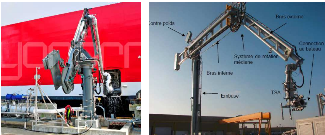
Figure 15 : bras de soutage d'un navire (à gauche) / bras de déchargement (à droite)
