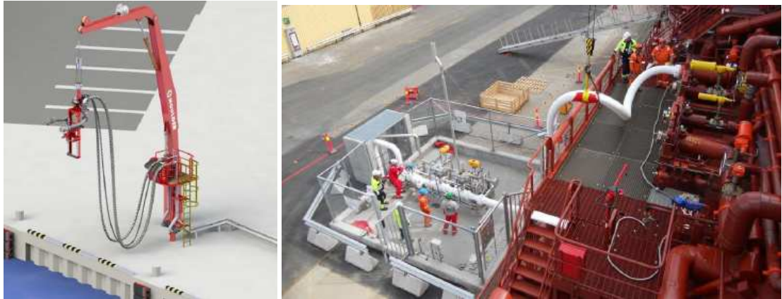
Figure 18 : flexibles soutenus par une potence (à gauche) / déchargement de navire par un flexible (à droite)
